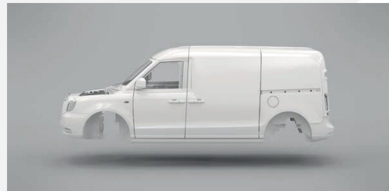
SMC-paneler som har lätt vikt men är robusta ger optimal hållbarhet.
